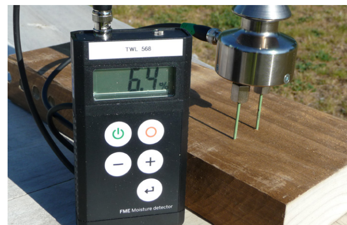
STIFTFÖRMIGES FEUCHTEMESSGERÄT (PIN-METER)
